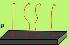
Schraube die Drähte auf die Grundplatte. Einen Draht lässt du gerade, einen biegst du enstprechend einem "S", einen wie eine menschliche Wirbelsäule und mit dem Vierten experimentierst du.
